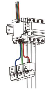
**Schritt B:** Schließen Sie jeden Leiter an das passende, zählerseitige Hauptversorgungskabel an und stellen Sie sicher, dass die Messklemme-A an das Phase A-Kabel, die Messklemme-B das Phase B-Kabel usw. angebracht wird. Gleichzeitig muss sichergestellt werden, dass die Richtung des Pfeils auf der Messklemme mit der Richtung des Hauptstroms übereinstimmt.
