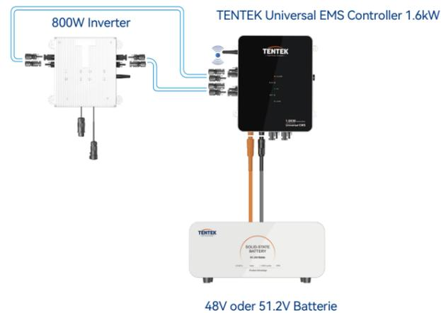
**Vorsicht:** Für einen sicheren Betrieb und die Einhaltung der Vorschriften wird dringend empfohlen, einen separaten DC-Überstromschutz oder eine Trennvorrichtung zwischen der Batterie und dem Controller zu installieren.
