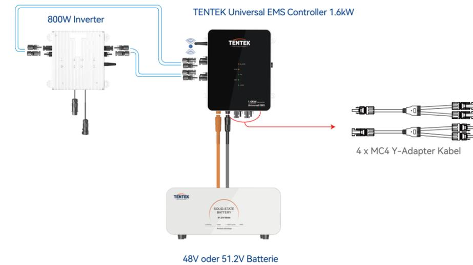
**Hinweis:** Der 1.6kW Controller verfügt über zwei unabhängige MPPT-Eingänge, die jeweils Pannelleistungen von 800W bis 900W pro Eingangskanal unterstützen
