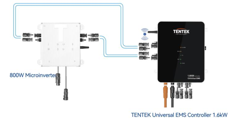
**!** **Achtung:** Für die DC-Verbindungen benötigen Sie geeignete Steckverbinder, die mit den Microinverters und dem Controller kompatibel sind. Zu den in Solaranlagen häufig verwendeten Steckern gehören MC4-Stecker oder Amphenol-Stecker.
