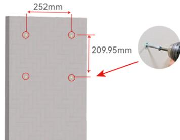
1. Richten Sie den Controller mit seinen Befestigungslöchern aus und setzen Sie zwei Schrauben in die Oberseite des Controllers ein.
