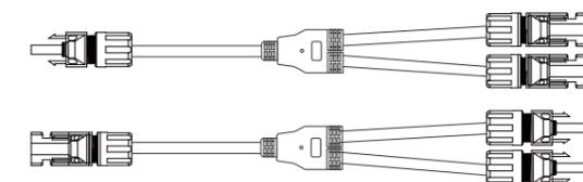
**2. Anschluss der Solarmodule:** Verbinden Sie die männlichen und weiblichen Kabel der Solarmodule mit den entsprechenden Eingangsanschlüssen des Controllers. Stellen Sie sicher, dass die Stecker sicher befestigt sind, um ein versehentliches Trennen zu verhindern.
