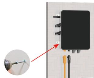
3. Verwenden Sie abschließend zwei weitere Schrauben, um die Befestigung zu vervollständigen, indem Sie sie in die Unterseite des Controllers fest schrauben.
