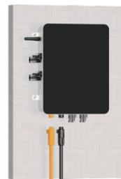
2. Senken Sie den Controller leicht ab, so dass er auf der kürzeren Seite des Befestigungslochs aufliegt. Sobald der Controller in Position ist, ziehen Sie die Schrauben fest an.
