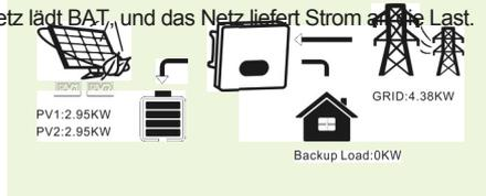
Beispiel 2:  $BAT < PV < BAT + Last$ , PV lädt zuerst die BAT, und PV+Netz versorgt die Last mit Strom.
