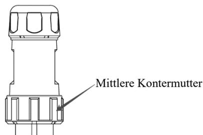
Abb. 2-7 Mittlere Kontermutter
