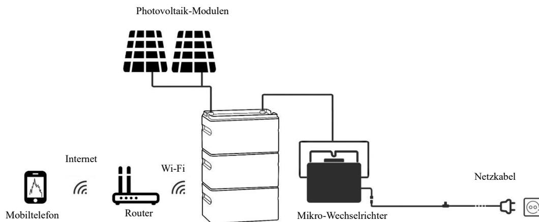
Abb. 2-1: Empfohlene Systemkonfiguration
