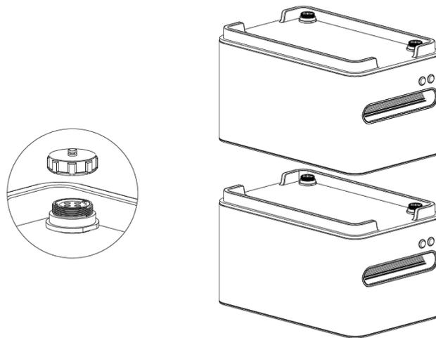
Abb. 2-2 Entfernen der Schutzkappen der Ein- und Ausgangsklemmen
