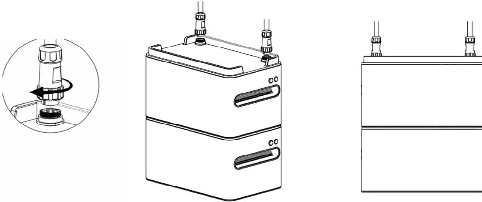
2-4 Verbindungskabel zum Anschließen der PV und Mikro-Wechselrichter
