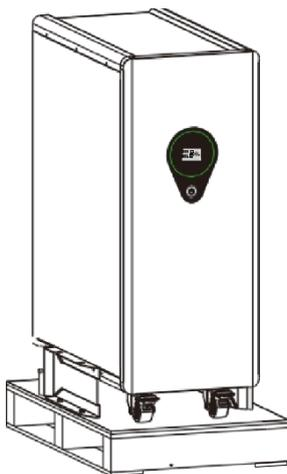
Schritt 2: Entfernen Sie die Befestigungsschrauben der Palettenbefestigung
