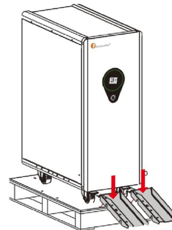
Schritt 4: Schieben Sie das Produkt auf der Palette entlang der Stufen nach unten und bringen Sie es in die Installationsposition.
